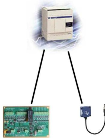
**Figure 2 : Topologie interne de la borne de recharge**
