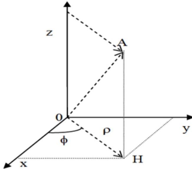
FIGURE 2.2 – Vecteur position d'un point A
