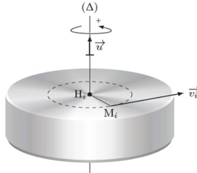
FIGURE 4.12 – Solide en rotation autour d'un axe fixe
