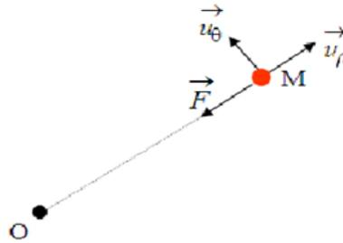
FIGURE 4.9 – Système soumis à une force centrale
