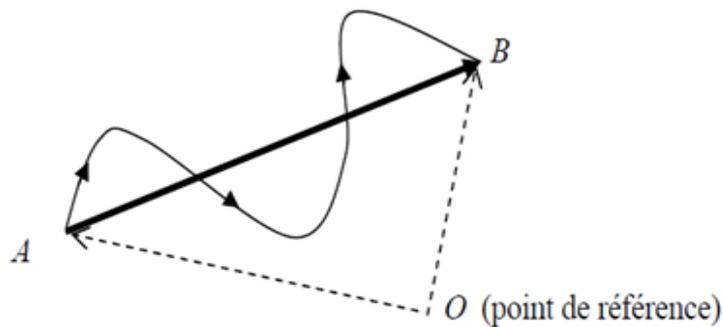
FIGURE 2.1 – Position, déplacement et trajectoire d'un point
