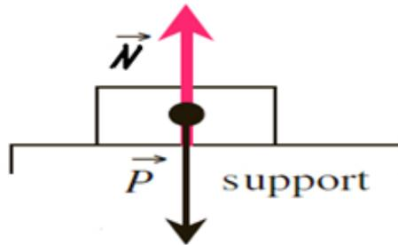
FIGURE 3.4 – Réaction Normale
