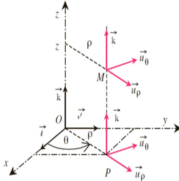
FIGURE 2.6 – Coordonnées cylindriques
