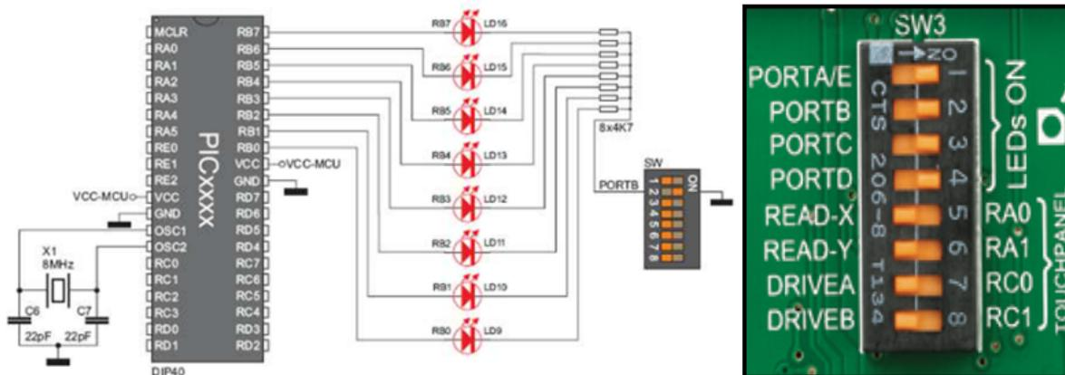
Figure 22. Description de connexions des 8 LEDs avec le PIC.
