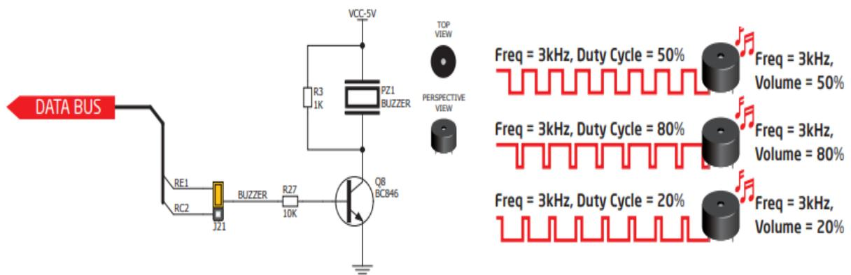
Figure 28. Schéma de connexion de Buzzer piézoélectrique connecté à la broche du microcontrôleur RE1.
