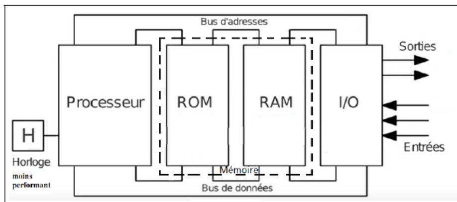
**Figure 1. Eléments d'un système à micro contrôleur.**
