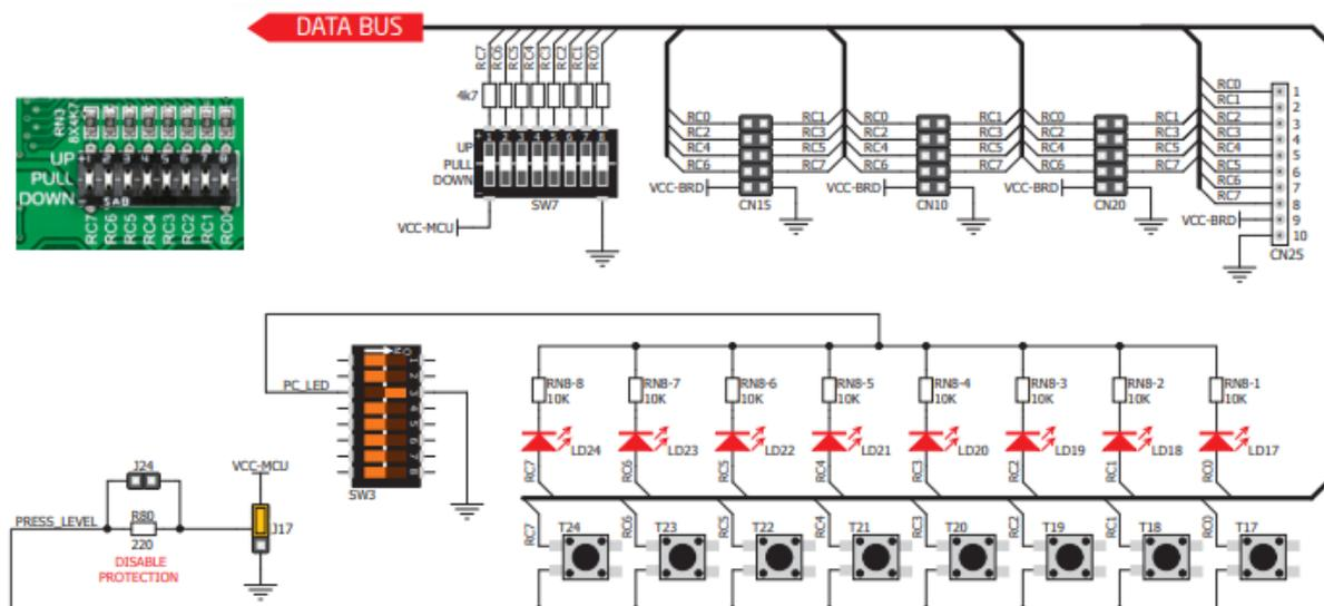
Figure 10. Schéma du groupe d'E/S connecté au port PORTC du microcontrôleur.
