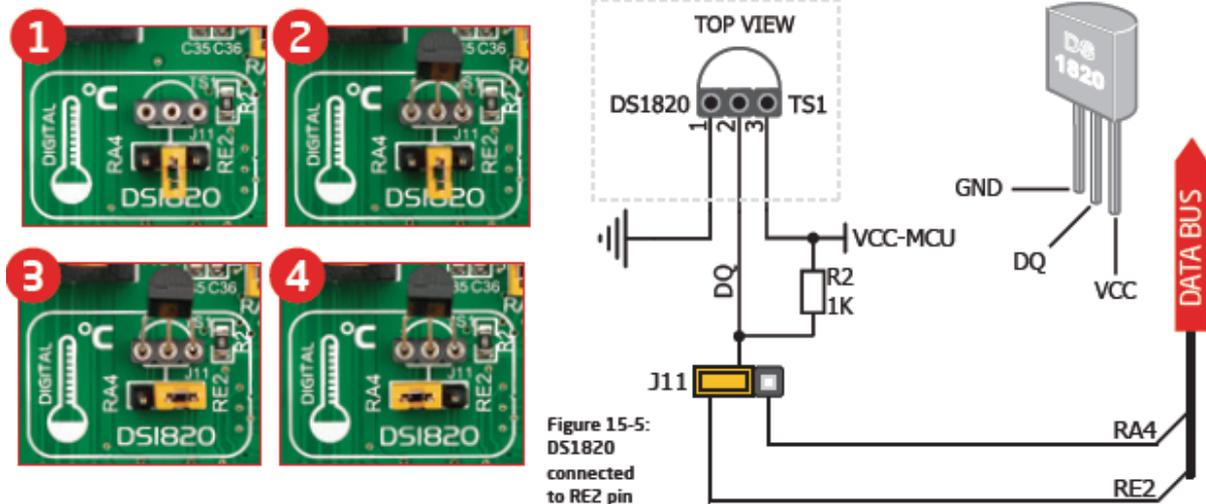
Figure 27. Schéma de connexion d'un capteur de température numérique DS1820 et activation du capteur.
