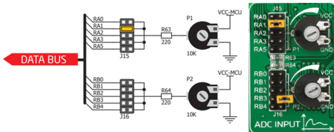
Figure 11. Schéma d'entrée de convertisseur analogique-numérique (CAN)
