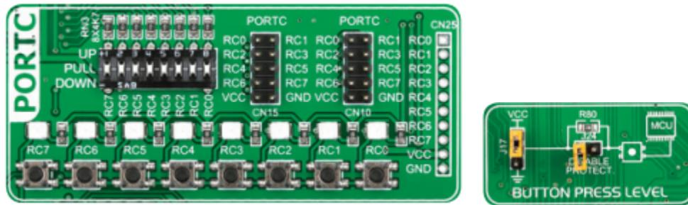
Figure 9. Connexions des boutons poussoirs aux ports.
