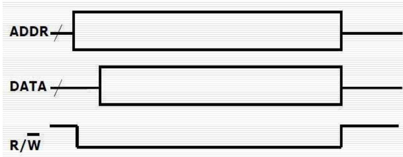
Figure : Principe d'Écriture
