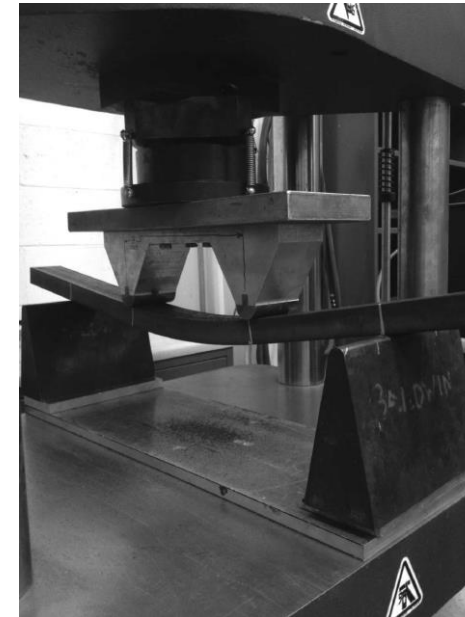
Figure. 1: Poutre en flexion
