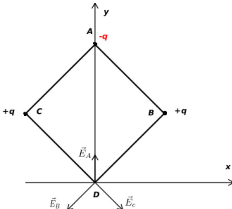
$\vec{E}_A$ ,  $\vec{E}_B$  et  $\vec{E}_C$  représentent les champs électriques générés par les charges se trouvant en  $A$ ,  $B$  et  $C$  au point  $D$ . En prenant compte du signe des charges impliquées, on peut écrire ;
