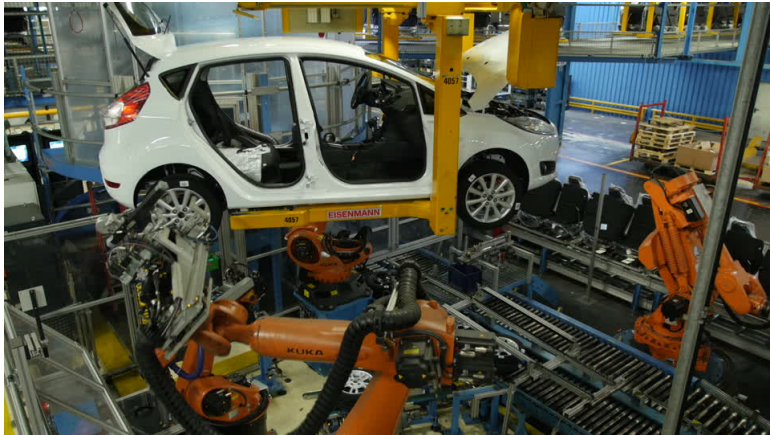
Figure – Application d'un bras robot automatique
